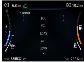
TCU Интерфейс поиска неисправностей
